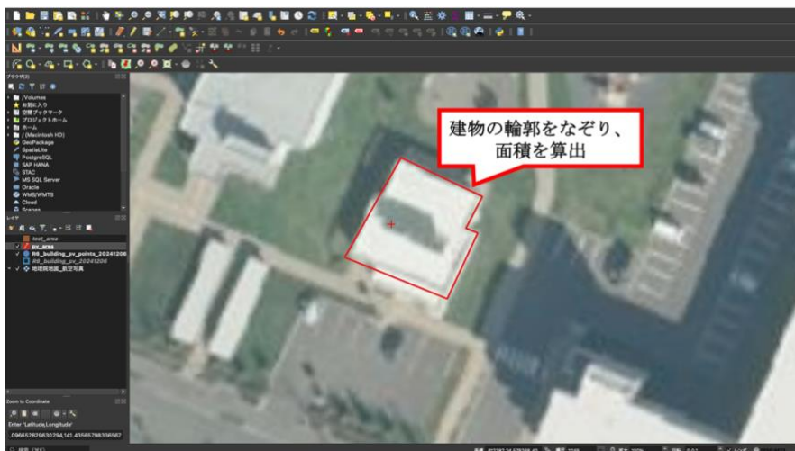
図 5.3.1-2 建物系 PV において太陽光パネルの輪郭が明確でない 場合の建物の面積取得
