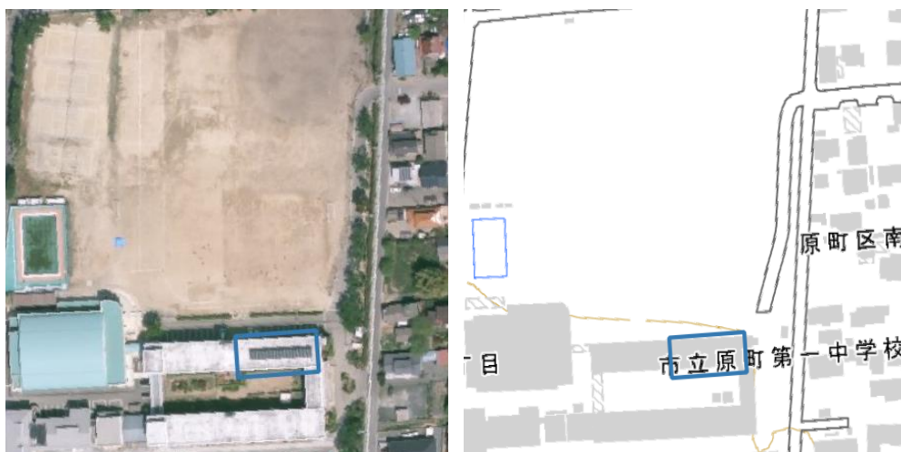
図 4.1.2-1 PV の位置情報と地図を用いた PV の属性の確認例
