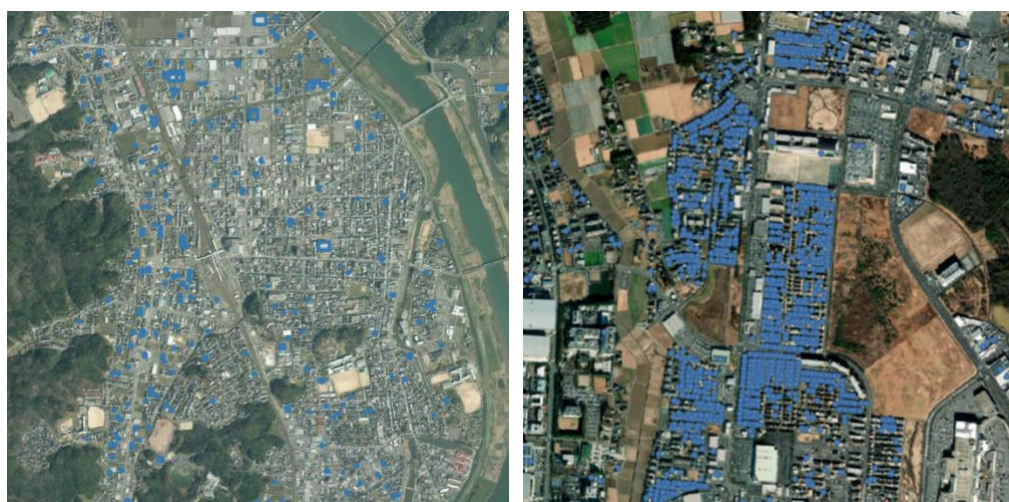
図 3.1-1 建物系 PV の矩形（左）、ポイントデータ（右）の例
