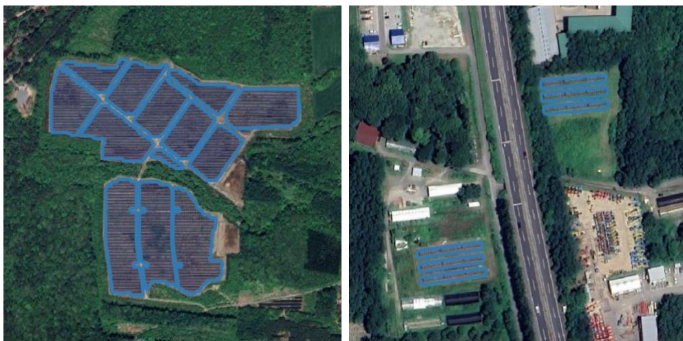
図 3.1-2 土地系 PV のポリゴンデータの例
