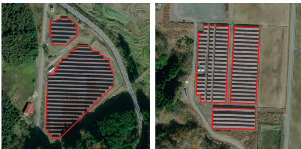
図 5.1.2-5 土地系 PV における PV 面積の定義
