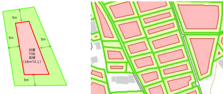
図 3.2.1-16 営農型太陽光の設置可能面積算定イメージ
