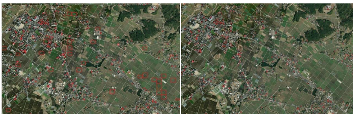
図 3.2-12 衛星画像の田畑の誤検出（左：対策前、右：対策後）
