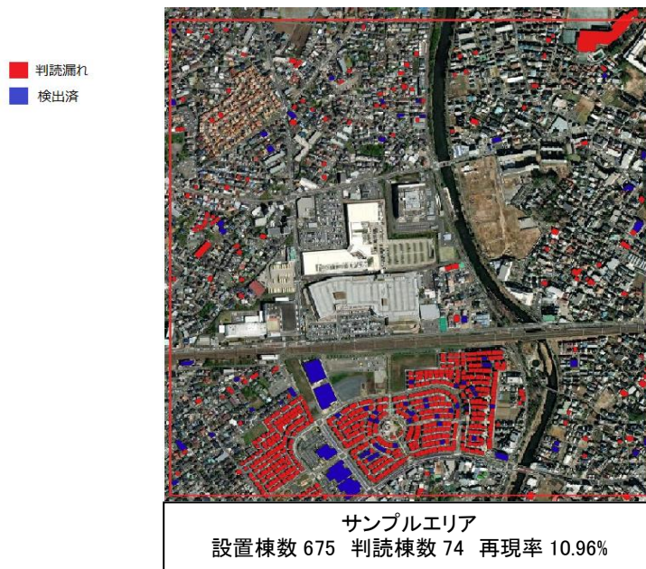
図 3.2-6 当初の衛星画像を用いた PV 判読結果の網羅率検証
