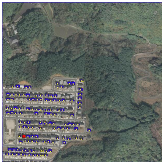
サンプルエリア 1 設置棟数 120 判読棟数 119 再現率 99.17%
