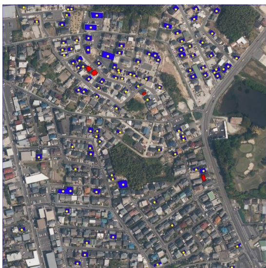
サンプルエリア 3 設置棟数 108 判読棟数 104 再現率 96.30%
