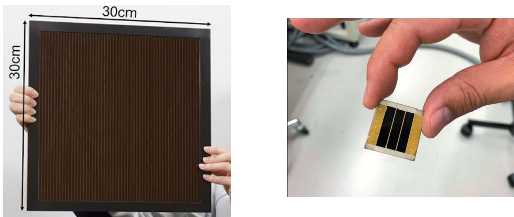
図 5.1-23 ペロブスカイト太陽電池のモジュール
