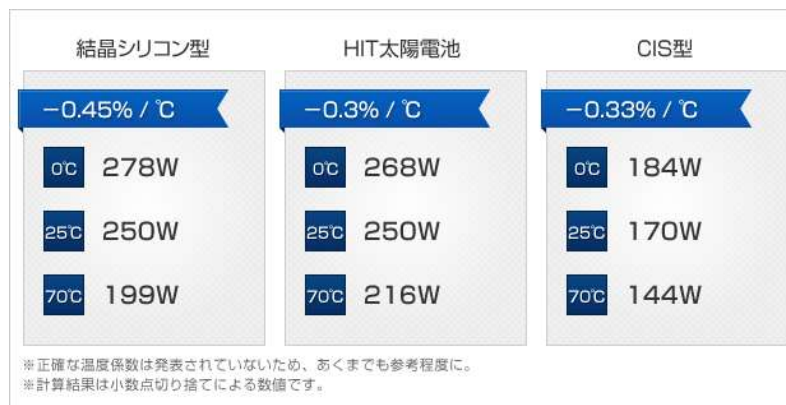
図 5.1-10 太陽光発電のソーラーパネルの素材別の出力変化率 出典：太陽光ビジネス HP
