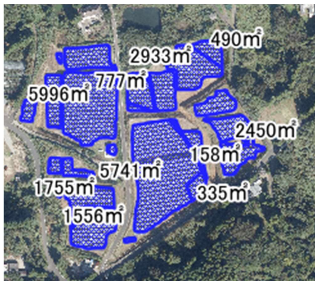
図 3.1-51 事業系太陽光パネルの面積算出結果
