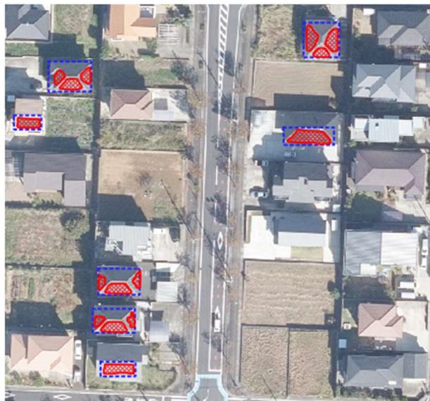
図 3.1-48 住宅系太陽光パネルの抽出結果
