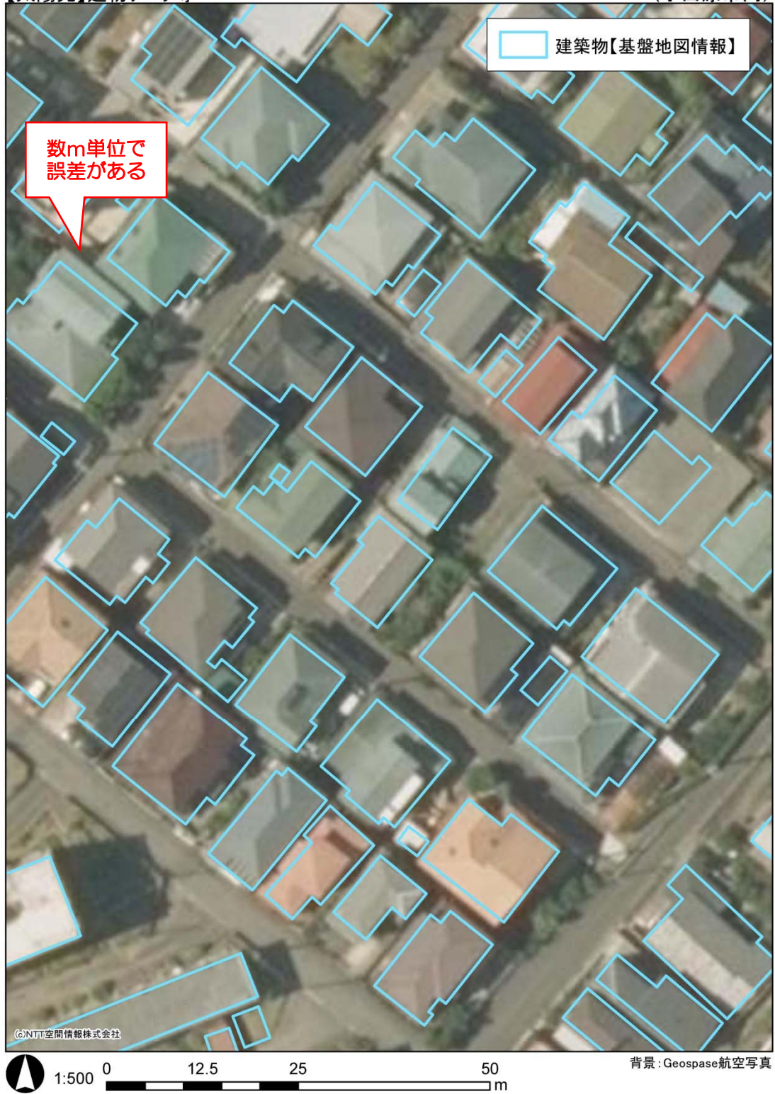
図 6. 4-6 航空写真データと基盤地図情報のオーバーレイ
