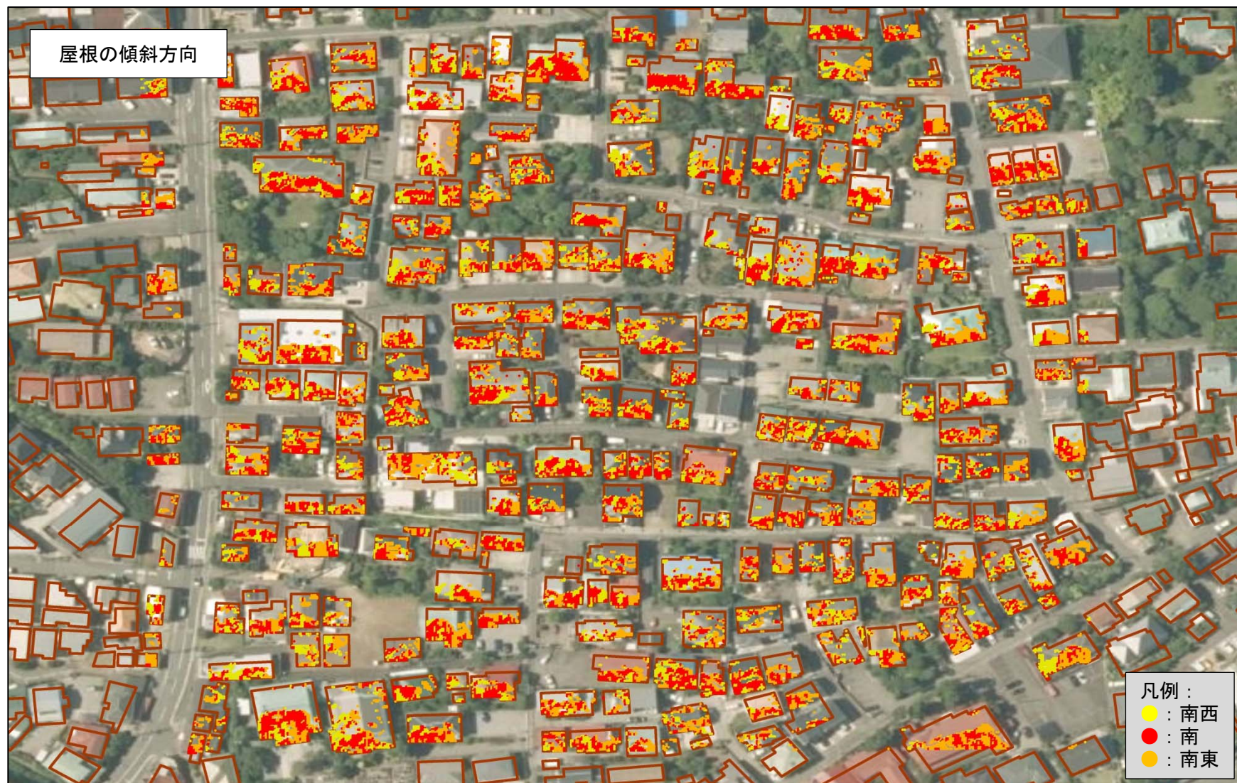
図 6.4-9 AW3D 全世界デジタル 3D 地図を用いた屋根の傾斜方向図
