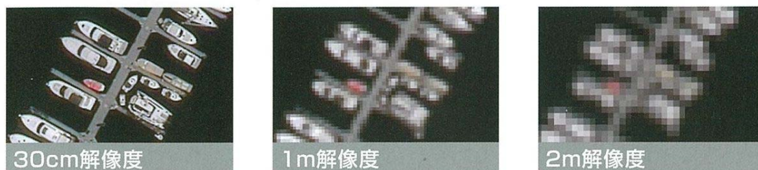
図 6.4-3 空中写真の解像度により見え方の違い
