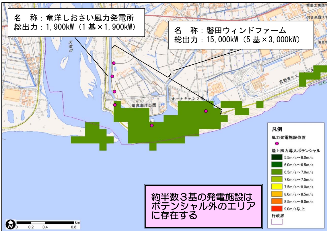
図 5.1-3 導入ポテンシャルの分布域と発電施設の位置関係（磐田市；拡大図）
