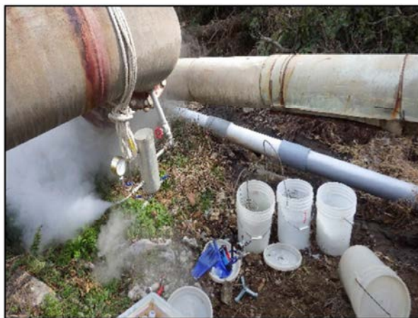
写真 7. 4-1 トレーサー注入箇所及び試料採取箇所：杉乃井ホテル（3号井）
