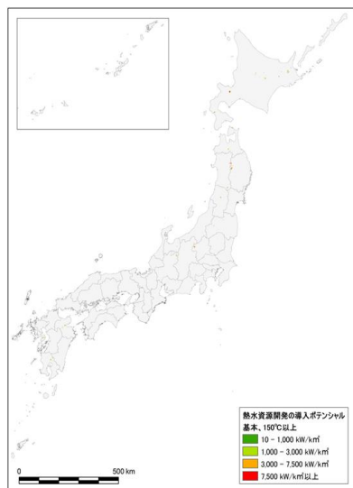
図-5 地熱発電に関する導入ポテンシャルの再推計結果（150℃以上、基本となる導入ポテンシャル）
